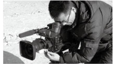
PDW-700光驱口有两个密封盖，能有效防止灰尘的进入，后来拍摄证明，PDW-700经得起风沙扬尘的考验；拍摄过程中，我们每天都要驱车几百公里，有时需要在车中拍摄，沿途路况也不太好，PDW-700使用了四个橡胶阻尼来固定光驱，有效吸收了路途颠簸造成的光驱震动，证明专业光盘设备具有很好的抗震动性能；今年1月，当我们到达塔里木河拍摄地点的时候，气温在零下26℃左右，河水完全结冰，但PDW-700经受了严寒的考验，其防冻抗寒性能保证了设备工作的稳定性。”
