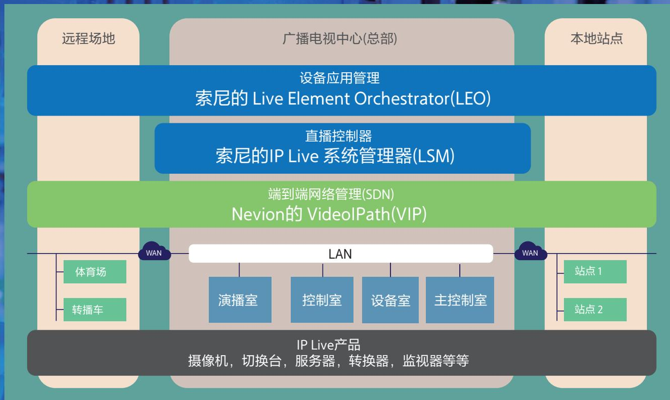
IP Live开辟了一条行业内互操作性的道路, 索尼一直推动着它的发展, 以后仍将不遗余力地继续下去。索尼一直与标准化协会、联盟伙伴和用户紧密合作, 并积极参加其他联盟和多种互操作活动, 旨在确保IP技术的标准化。索尼在产品线上支持IP开放标准格式的SMPTE ST2110<sup>1</sup>的媒体传输协议, 支持NMOS协议进行设备发现和注册, 进一步推动IP Live节目制作的互操作性。
